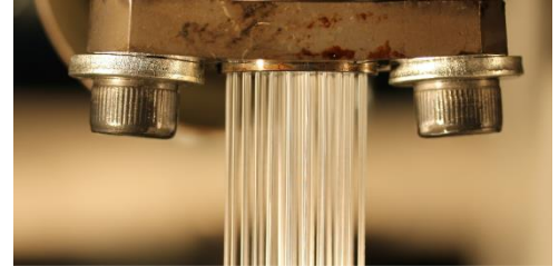
Schmelzspinnprozess zur Herstellung von Filamentgarnen
